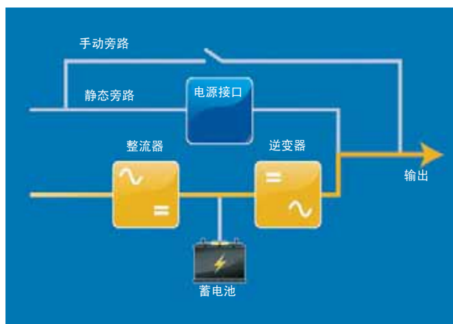
图7 - 采用Trinergy但仍以双变换模式工作的新型无变压器UPS。
