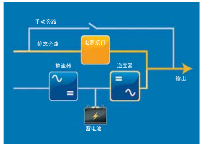
图6 - Trinergy 技术。经过配置后的UPS可将IGBT逆变器用作以串联或并列模式配置的有源滤波器，以此方式自动补偿网络中的部分扰动，但仍通过静态旁路通道为负载供电。
