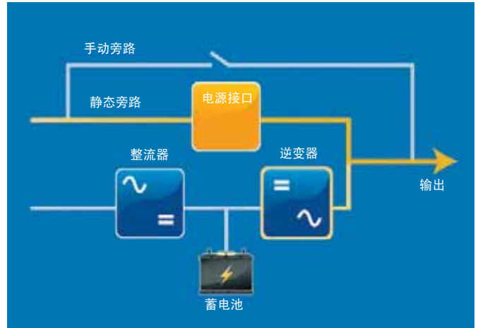
图9 - 在线路交互模式下通过有源滤波器为市电或负载扰动提供补偿且采用Trinergy技术的新型无变压器UPS。
