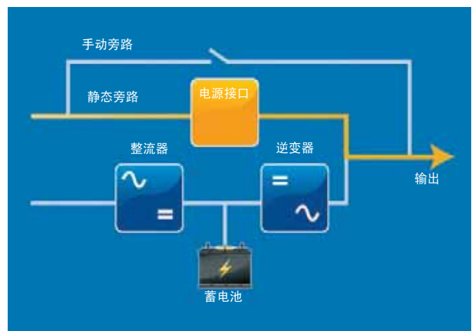
图8 - 在数字交互模式下工作且采用Trinergy技术的新型无变压器UPS。
