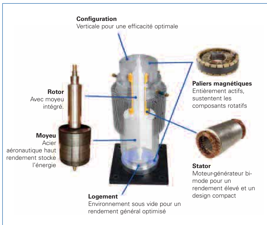
Figure 1 - Structure interne de la masse rotative.
