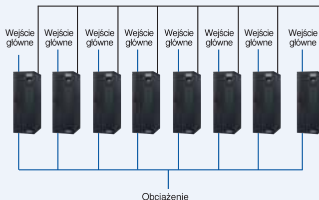
Rysunek 2. Konfiguracja równoległa w celu zwiększenia mocy i/lub uzyskania redundancji
