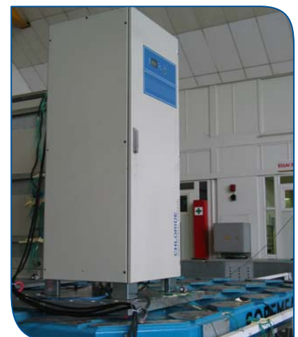
Рис. 5. Зарядное устройство при проведении испытаний на сейсмическую устойчивость
