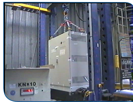
Рис. 4. Тест на взвешивание. Усилие подъема 40,2 кН (4,1 т)
